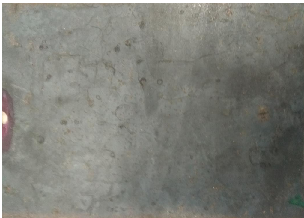
Рис. 5.26. Внешний вид листовой Ст. 3 сп без EPS очистки поверхности металла после непрерывного действия нейтрального соляного тумана в течение 0,5 ч.
