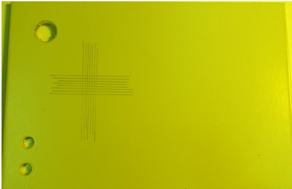
Рис. 4.8. Листовая сталь без обработки EPS без фосфатирования (оборотная сторона)
