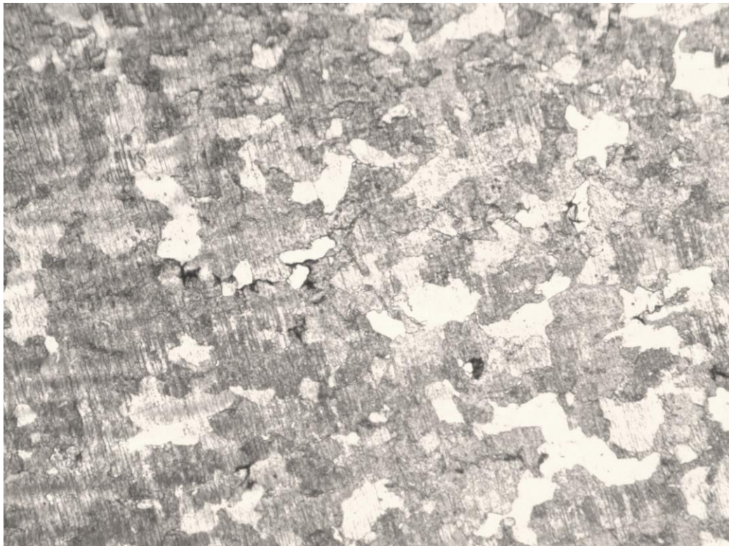
Рисунок 1.10. Микроструктура образца 1 после плазменной резки
