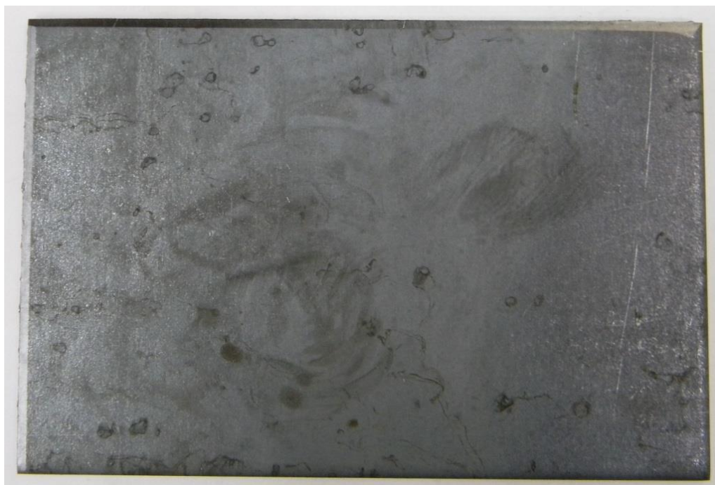
Рис. 5.23. Листовая Ст. 3 сп без EPS очистки поверхности металла
