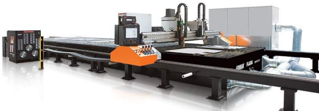
Рисунок 1.1.-Внешний вид установки ERMAKSAN EPL 2060
