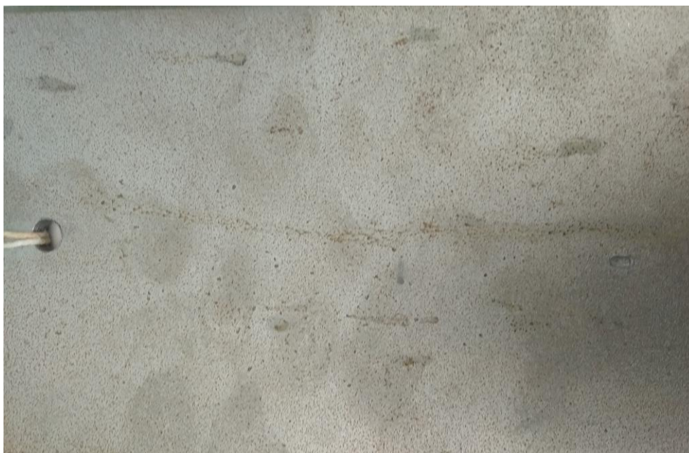
Рис. 5.27. Внешний вид листовой Ст 3 сп с EPS очистки поверхности металла после непрерывного действия нейтрального соляного тумана в течение 0,5 ч.
